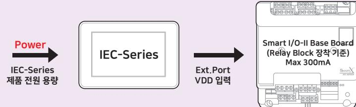
Power = IEC-Series 전원 용량 + Smart I/O Base Board에서 사용되는 VDD 용량(300mA) + 30%
