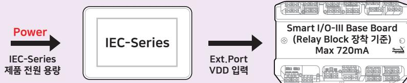
**Power** = IEC-Series 전원 용량 + Smart I/O Base Board에서 사용되는 VDD 용량(720mA) + 30%
